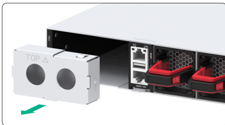
图2-34 电源假面板拆卸示意图（以 S9600XP-24B16DH-G 为例）
